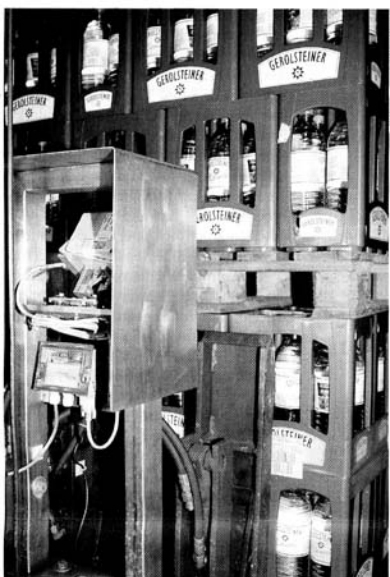
Innovativ: Gerolsteiner verfolgt die Stapler durch RFID-Tags im Lagerboden – und scant die Paletten zusätzlich beim Heranfahen.
