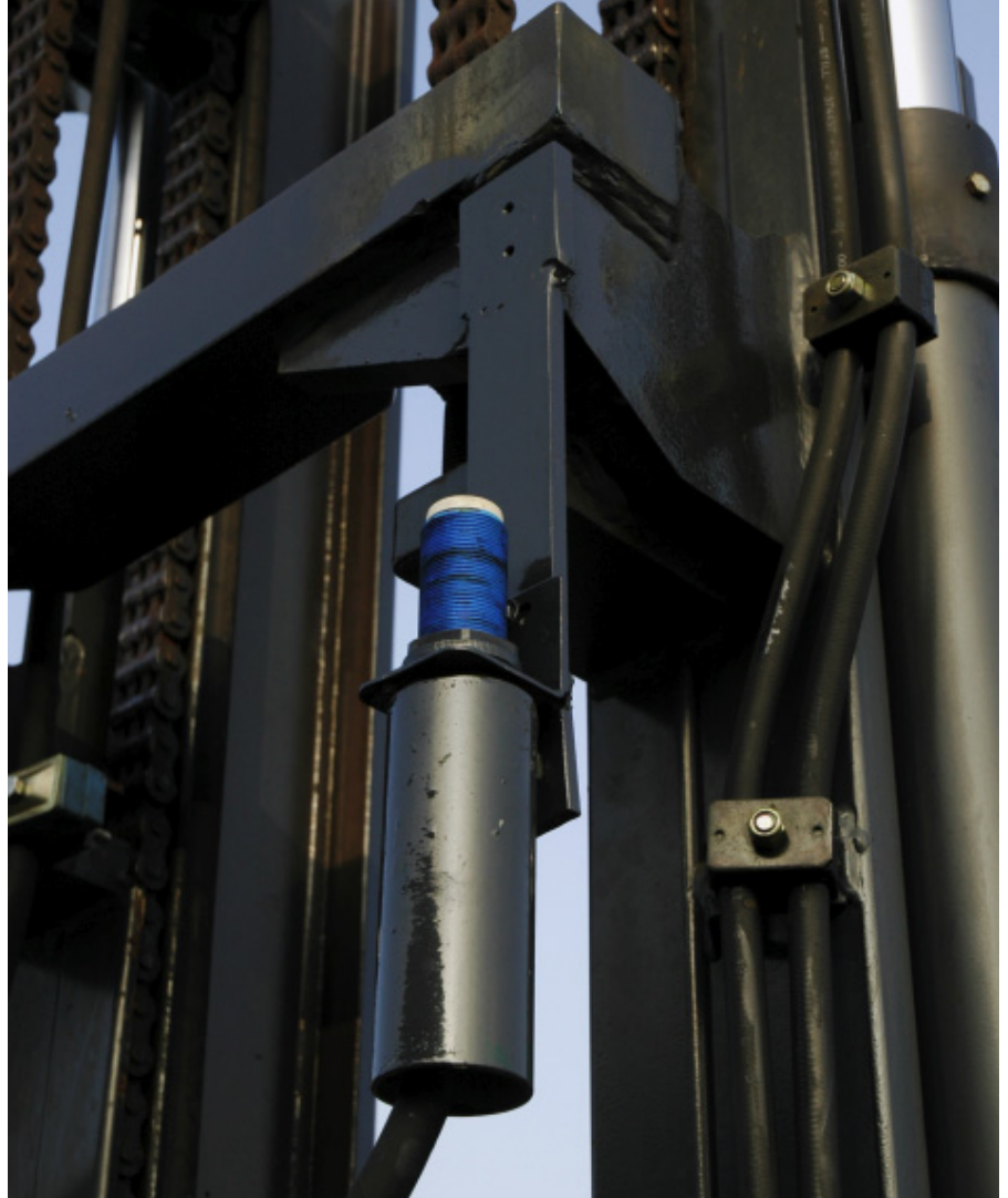
Dieser Höhensensor am Schubmast ermittelt die exakte Position des Lastaufnahmemittels.
