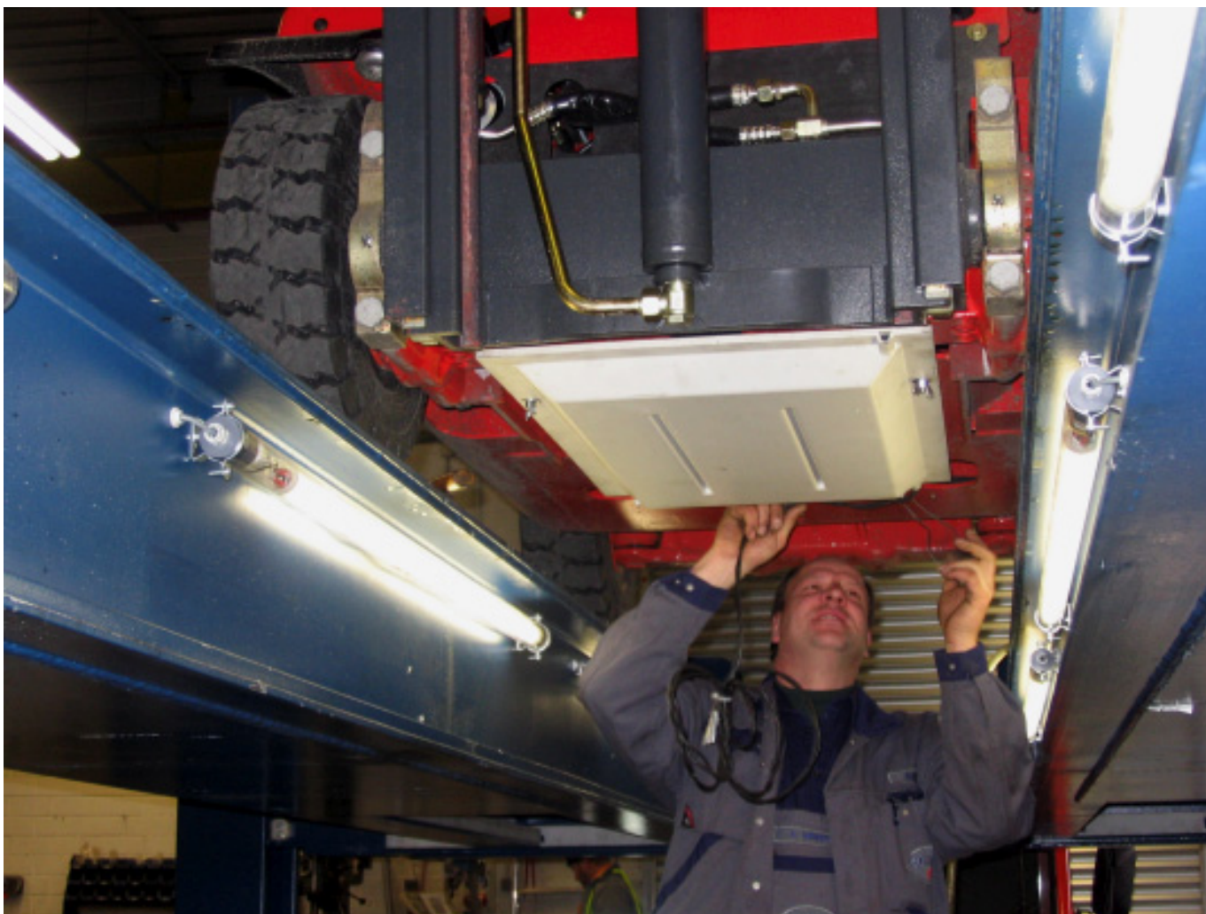
Die Antenne für das intelligente Warenverfolgungssystem Track+Race wird am Stapler montiert. (Bilder: Indyon)
